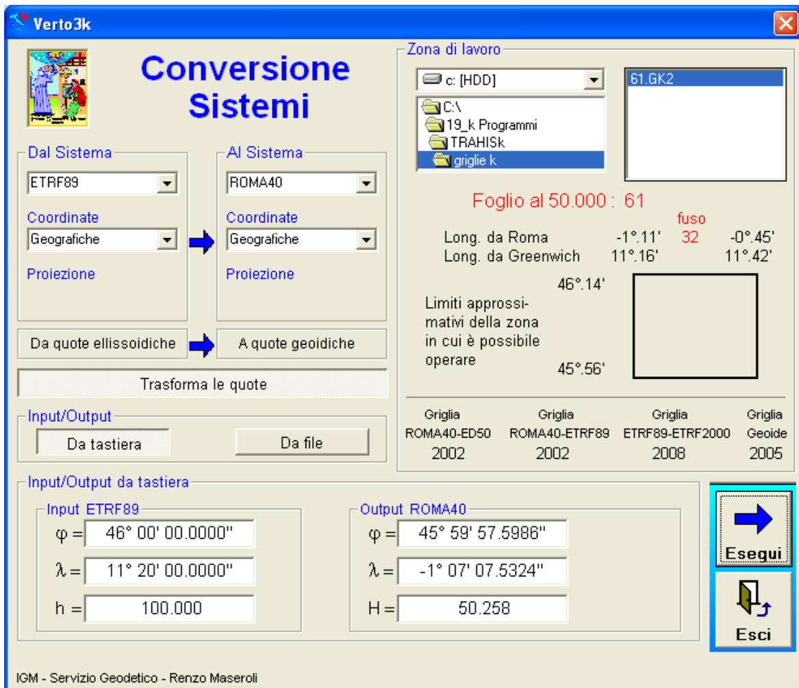
L'input da tastiera, utile nel caso di un numero limitato di punti da trasformare, fornisce risultati direttamente sul video. Non è possibile in questo caso la stampa dei risultati. Per inserire le coordinate in input è necessario cliccare nei relativi text box. La pressione del tasto "Invio" consente di passare da un campo all'altro secondo una logica che di norma risulta vantaggiosa. Non è attivo il tasto "Tab".
