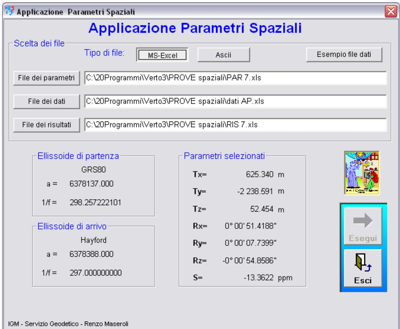
Durante l'esecuzione il software riporta sul monitor i parametri in uso e le costanti degli ellissoidi di partenza e d'arrivo. Le coordinate nel sistema d'arrivo vengono calcolate applicando ancora le relazioni di Molodensky già precedentemente riportate.
