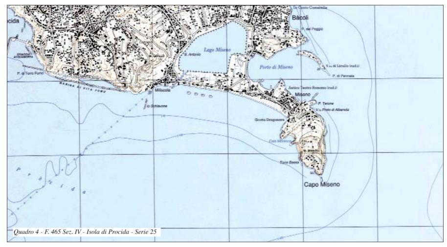
L'acquisizione di tale configurazione farebbe sì che le onde dei mari dominanti giungessero a riva ortogonalmente in ogni tratto ed il trasporto litoraneo fosse ridotto a tutto vantaggio della stabilità della spiaggia. Purtroppo l'approfondimento della spirale sta determinando anche un'erosione regressiva che porta all'eliminazione dei tomboli ed alla destabilizzazione di tutto il sistema di difesa costiera.
